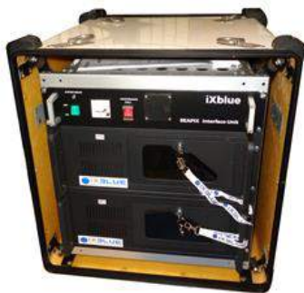
Figura 1: Unidades procesadoras, unidad de interfaz del sonar Seapix
