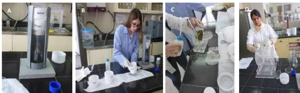
Figura 6. Proceso de tamizado y cuarteamiento. A. Acoplamiento de set de tamices de 1 mm y 300 µm. B. Lavado del tamiz sobre la placa Petri. C. Transferencia parcial de swimmers + detritos a la cámara de conteo. D. AFIOQG, LGM, IMARPE.
