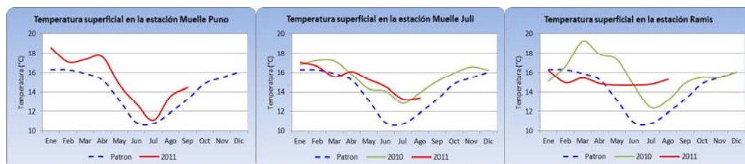
Figura 1.- Variación temporal de la temperatura superficial del lago en las estaciones fijas Muelle Puno, Juli y Ramis, tercer trimestre 2011.
