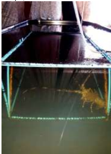
Figura 5.- Pruebas en condiciones controladas de laboratorio: langosta viva capturada en la nasa empleando el diseño final.
