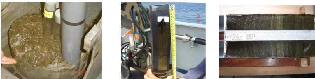
Fig. 1 Sub-muestras obtenidas del Multicorer (Izq. y Centro) y sección de testigo frente a Pisco (Der.)
