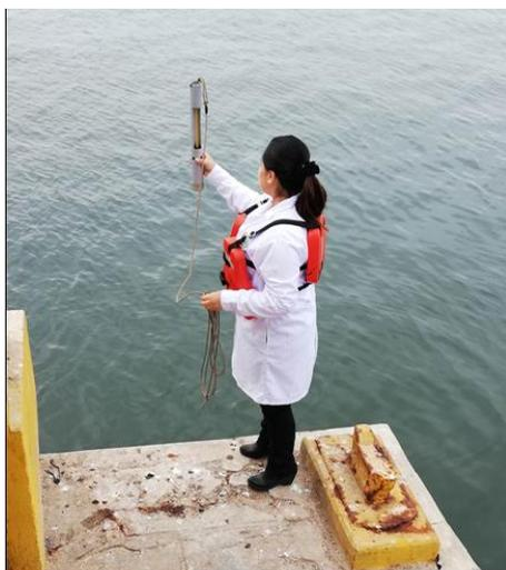
*Registro de la temperatura superficial del mar con termómetros de inmersión total en el muelle del IMARPE en Callao. Esta forma de medición se empleó en la estación CALLAO hasta el año 2017.*
