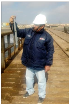
Registro de la temperatura superficial del mar con termómetro de inmersión total ASTM en el muelle del Puerto Malabrigo en Trujillo, Perú
