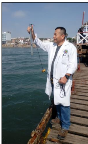
Registro de la temperatura superficial del mar con termómetro de inmersión total ASTM en el muelle de Huanchaco en Trujillo.
