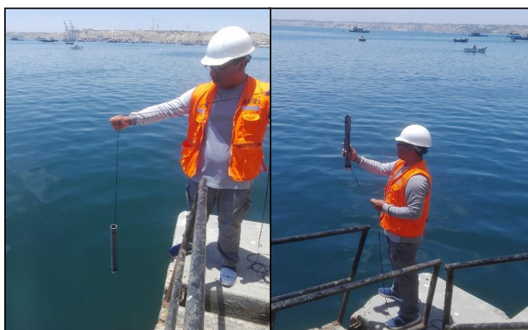
Registro de la temperatura superficial del mar en el muelle del Desembarcadero Pesquero Artesanal en Paita, Perú.
