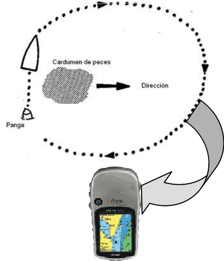
FIGURA 2 Estimación del área barrida de la red de cerco utilizando GPS Garmin Etrex Vista HCX
