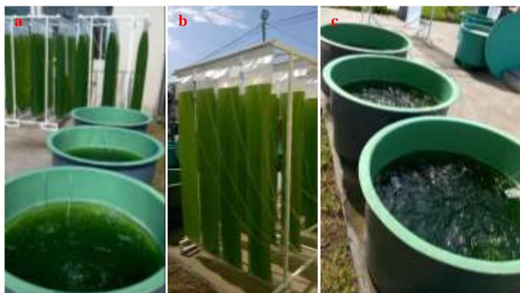
masivos de la microalga a) Ubicación final de los Sistemas de Biorreactores circulares de 120 L.
