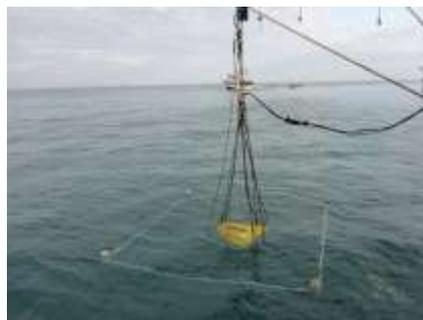
Figura 2. Disposición del transductor y la jaula de calibración
